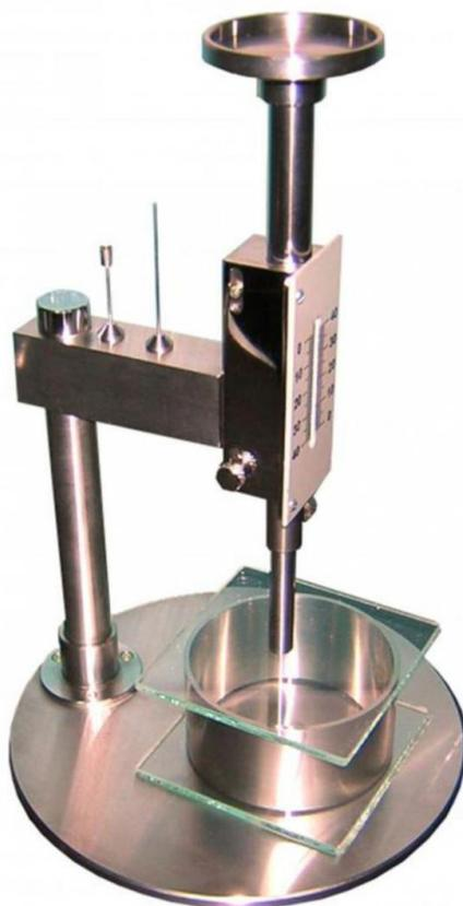
Рисунок 8 - Прибор Вика
